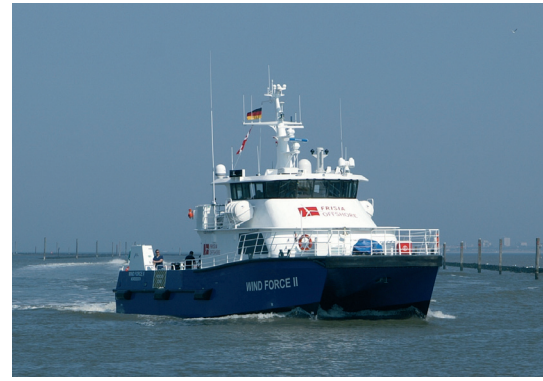
Für den Crew-Transport zu den Windparks in der Nordsee stellte die Reederei Norden-Frisia den Offshore-Katamaran Wind Force II in Dienst.
