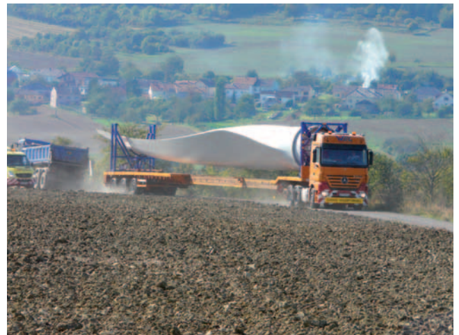
Der Transport eines rund 40 Meter langen Rotorblatts stellt eine Herausforderung für jeden Spediteur dar.
